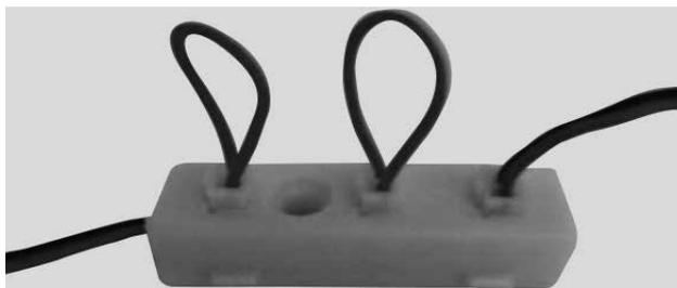
Ne rétablir l'alimentation électrique que si toutes les positions sur les blocs répartiteurs sont raccordées à des spots ou à des ponts (jumpers).
