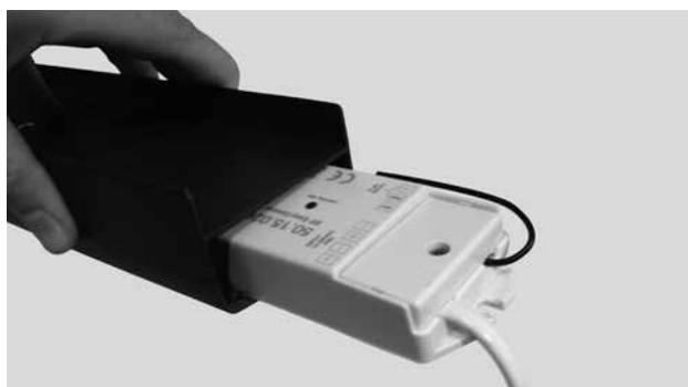
**Le récepteur doit tout d'abord être réglé et synchronisé avec la télécommande avant d'être entièrement dissimulé derrière les profils.**
