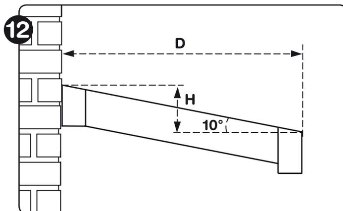
**10** Le clips latéral CLSL doit être découpé côté mural sous un angle de 10°. Attention ! La longueur change en fonction de l'épaisseur du vitrage ou en fonction de l'inclinaison !
