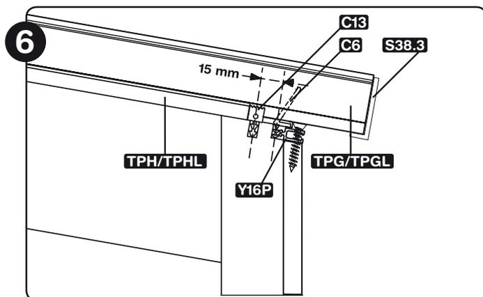
**4** Pour la finition latérale, placez le profilé TPHL au milieu du chevron latéral en bois. Fixez le joint C13, avec languette déchirée, entre le TPHL et le porteur en bois. Positionnez les profilés TPH sur les autres porteurs en bois et vissez-les tous les 50 cm (avec des vis à bois de  $4,5 \times 45$  à tête conique).
