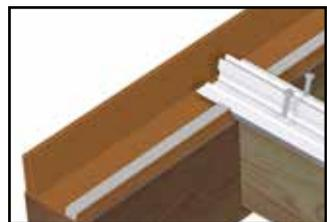
4. Adaptez les porteurs de vitrage TPG et TPGL à la longueur désirée et glissez-les dans les profilés en aluminium jusque contre le profilé mural MP. Bloquez-le uniquement en haut avec 2 vis. Fixez le joint C31 dans le profilé MP.
